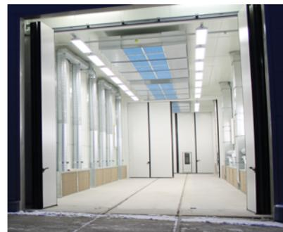
**Освещение** окрасочной камеры осуществляется при помощи комплекта светильников, выполненных во взрывобезопасном исполнении. Мощность светильников обеспечивает достаточное освещение для выполнения окрасочных работ в рабочей зоне камеры.
